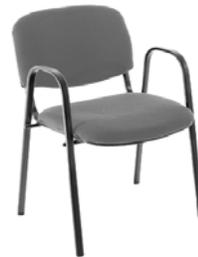
Estructura fabricada en tubo de acero ovalado de 5/8" x 1 1/8" en cal. 16 fosfatizada y pintada con pintura en polvo poliéster epóxico, horneado de 220 a 240°C, acabado gofrado (texturizado), la misma estructura forma los descansabrazos y cuenta con regatones de plástico, la distancia entre la pata frontal y la trasera no deberá ser menor de 39cm. Para lograr una estabilidad adecuada.
